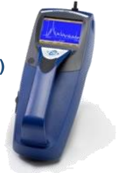
Streulichtphotometer Quelle: www.tsi.com
